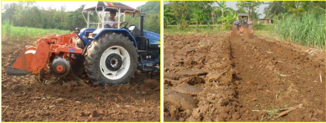
ถ้าเป็นการปลูกระหว่างแถวอ้อยต่อเก่าใช้ผลาลับใบก่อน แปลงที่ไม่มีใบคลุมดิน ใช้รีเปอร์ร่วมกับจอบหมุน ไถพรวนดินแนวปลูก
