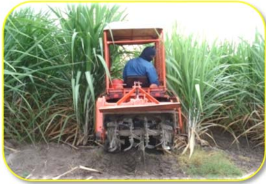
ใช้จอบหมุนติดท้ายรถแทรกเตอร์เล็กกำจัดวัชพืชไร่อ้อยที่ใช้ระยะปลูกระหว่างแถว 1.5 เมตร
