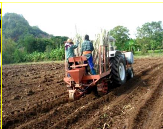
ปลูกอ้อยด้วยเครื่องปลูกอ้อยพร้อมถังหยอดน้ำใส่ปุ๋ย
