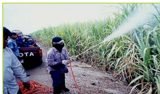
เครื่องพ่นสารไกลโฟเสทแบบเครื่องยนต์ มีสายส่งสารเคมี สามารถพ่นสารไกลโฟเสทได้ไกล
