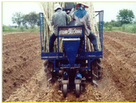
เครื่องปลูกอ้อยแถวคู่เหมาะกับพันธุ์อ้อยที่มีการแตกกอแน่น ทรงกอแคบ
