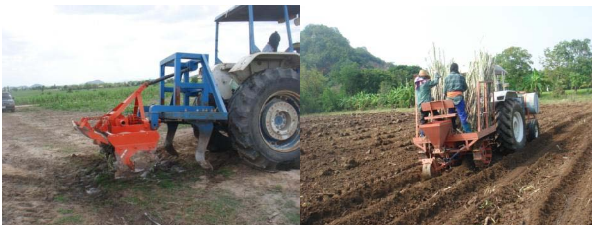
ปลูกอ้อยด้วยเครื่องปลูกอ้อยพร้อมถังหยอดน้ำใส่ปุ๋ย
