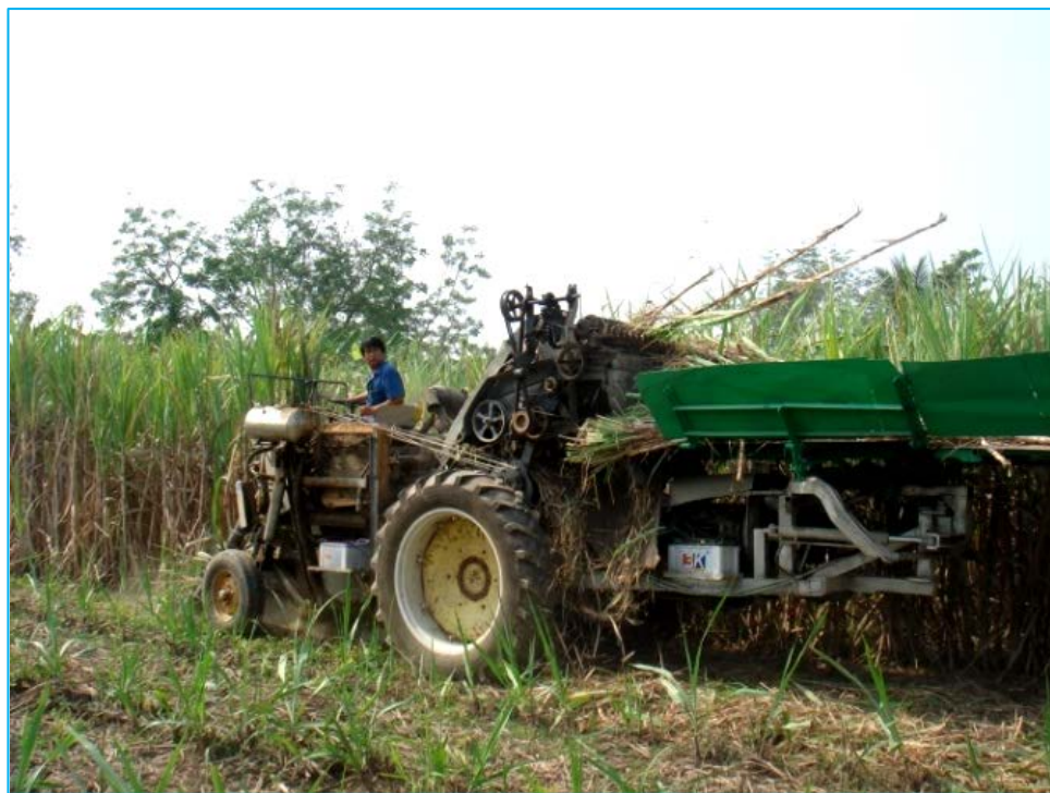
รถตัดอ้อยสดชนิดตัดเป็นลำที่ประดิษฐ์คิดค้นโดยกรมวิชาการเกษตรแต่ในขณะนี้ยังไม่มีผลผลิตจำหน่าย
