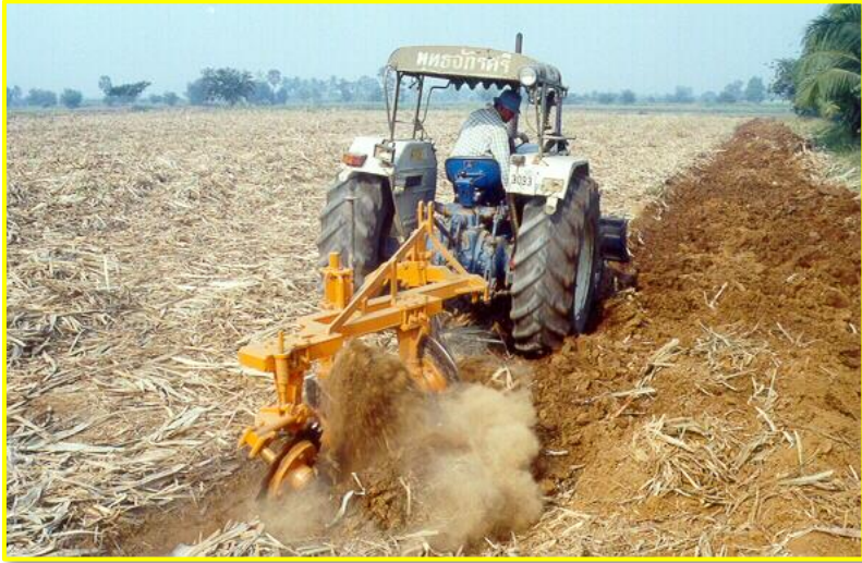
เครื่องลับใบและกลบเศษซากอ้อย
